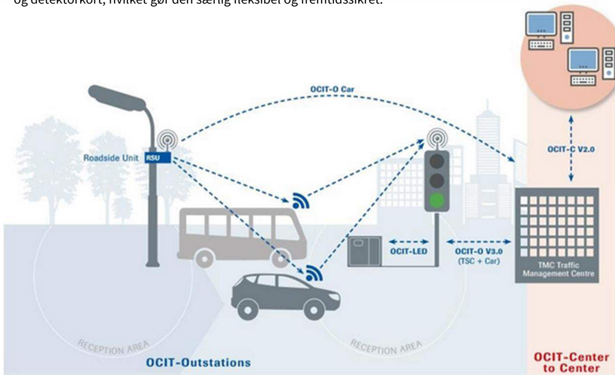
Figur 1 OCIT oversigt - Interfaces og protokoller
